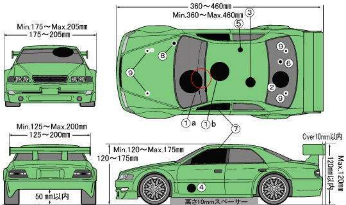
\* ①a 冷却用穴(最大 60mm)と①b 給油用の穴(最大 50mm)をそれぞれ開けることができるこの場合 5mm 以上はなれていなければならない、この場合冷却穴はフロントスクリーン、給油はルーフにそれぞれあけなければならない。
