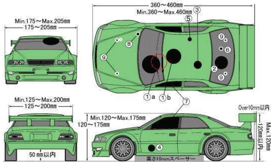
\* ①a 冷却用穴(最大 60mm)と①b 給油用の穴(最大 50mm)をそれぞれ開けることができるこの場合 5mm 以上はなれていなければならぬ、この場合冷却穴はフロントスクリーン、給油はルーフにそれぞれあけなければならない。
