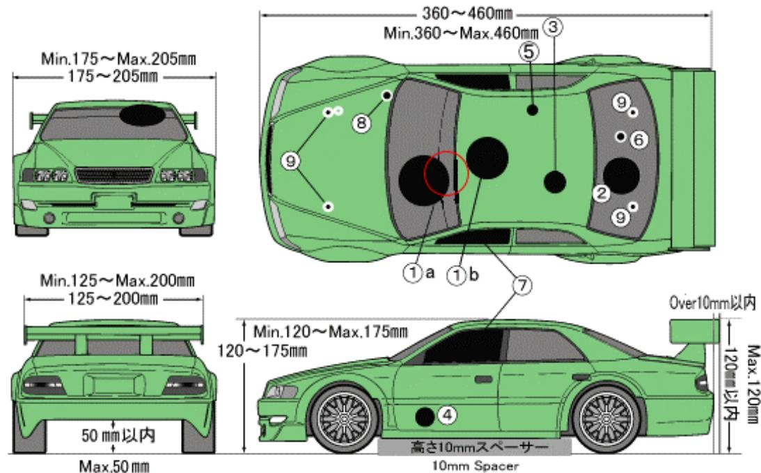
\* ①a 冷却用穴(最大 60mm)と①b 給油用の穴(最大 50mm)をそれぞれ開けることができるこの場合 5mm 以上はなれていなければならない、この場合冷却穴はフロントスクリーン、給油はルーフにそれぞれあけなければならない。
