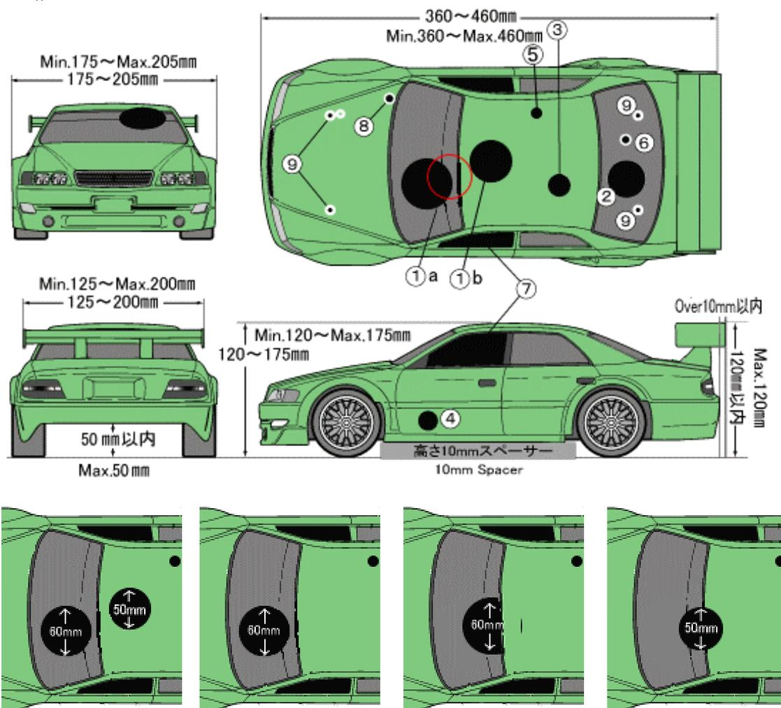
\* ①a 冷却用穴(最大 60mm)と①b 給油用の穴(最大 50mm)をそれぞれ開けることができるこの場合 5mm 以上はなれていなければならない、この場合冷却穴はフロントスクリーン、給油はルーフにそれぞれあけなければならない。
