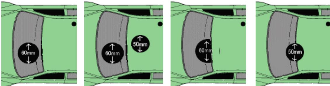
\* ①a 冷却用穴(最大 60mm)と①b 給油用の穴(最大 50mm)をそれぞれ開けることができるこの場合 5mm 以上はなれていなければならない、この場合冷却穴はフロントスクリーン、給油はルーフにそれぞれあけなければならない。
